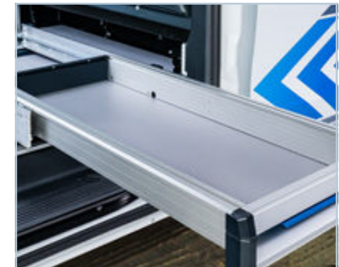
Robuste SoboGrip Mehrschichtplatte verhindert Rutschen der Ladung
