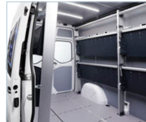
Klappbare Fachböden mit komfortabler Einhandbedienung
